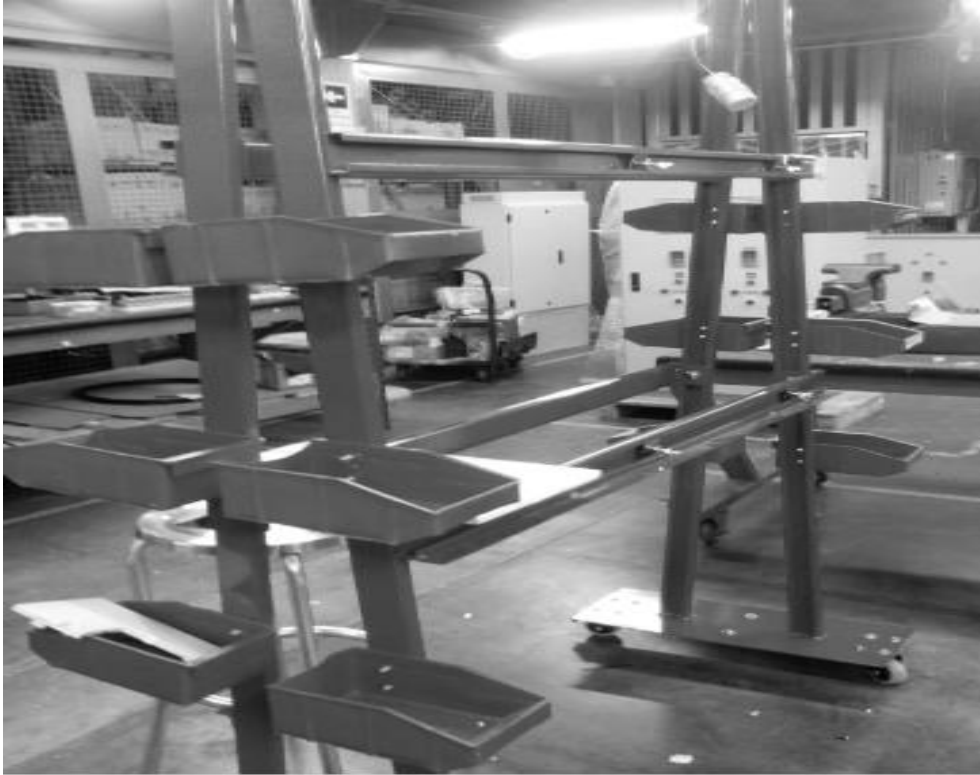
Figura 10: Carros móviles para ensamble de tableros eléctricos. Fuente: Autores.
