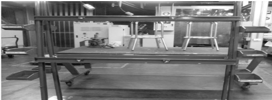
Figura 9: Carros móviles para ensamble de tableros eléctricos.
