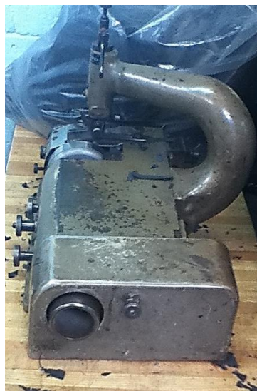
Ilustración 19 Area de finalizaje; Máquina pulidora: encargada de eliminar el grosor al material
