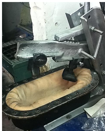
Ilustración 17 Máquina de presión encargada de brindar un pegado superior entre el zapato y la suela
