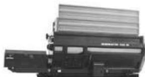
El modelo KOMPTECH MASHMASTER 1300 SE station es un homogeneizador triturador universal móvil y estacionario para preparar la materia orgánica y producir una mezcla inicial óptima para el proceso de compostaje.
