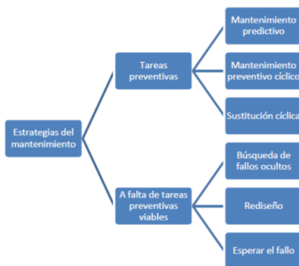
Figura 12. Esquema de RCM
