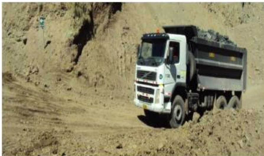
Ilustración 4. Volquete Volvo Gris FM 440 de 15 cubos. Fuente: Otazú (2019)
