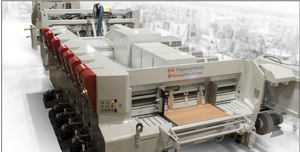
Nota: En la ilustración se muestra una impresora flexográfica de tipo foldeadora cuya función es realizar la conversión de la lámina de cartón corrugado, impresión, foldeado (doblado) y pegado de la misma. Fuente: <https://www.bwpapersystems.com/es/grupos-de-productos/maquina/equipo-de-acabado/impresora-flexografica-plegadora-encoladora/impresora-flexografica-plegadora-encoladora-g-grafix>
