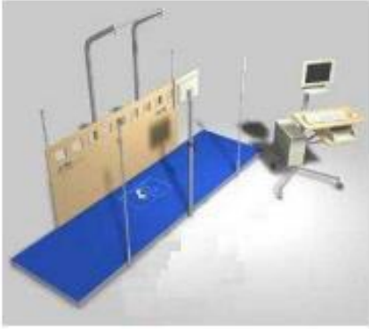
Figura 17. Plataforma dinamométrica de galgas extensiométricas. Fuente: (Sanchez Rey, 2010)
