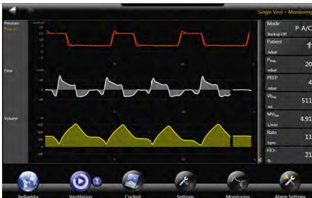
Ilustración 3 Compensación automática del tubo ATC
