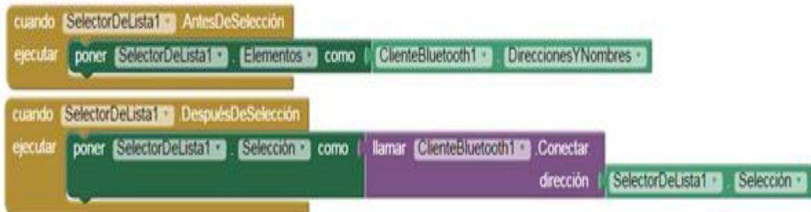
**Figura 25:** Comunicación PIC 16F877A – Android.
