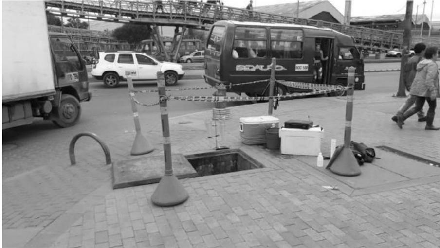
**Fotografía 2.** *Toma de agua en punto de monitoreo de agua residual*
