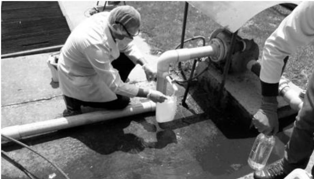
Se toma el balde y se toma la muestra de agua residual por el método volumétrico:
