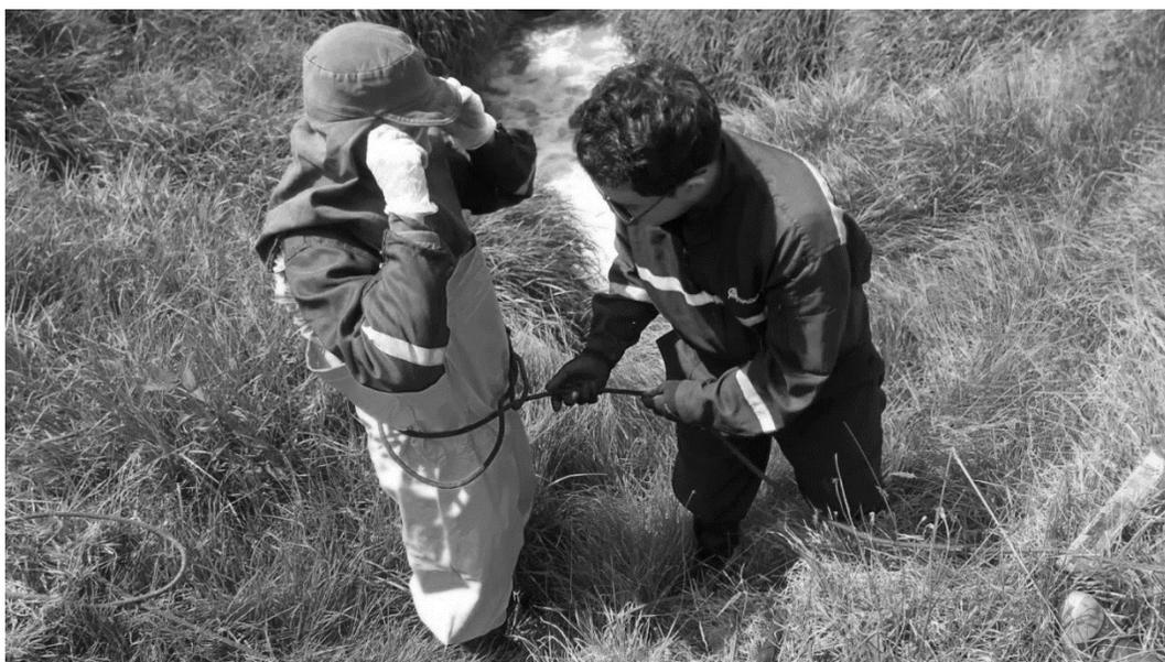
En esta toma de muestra de agua superficial, identificamos que, al realizar la línea de vida para la toma de muestras de aguas superficiales, uno de los técnicos de campo no hace uso del tapabocas, del capuchón, ni los lentes de seguridad.
