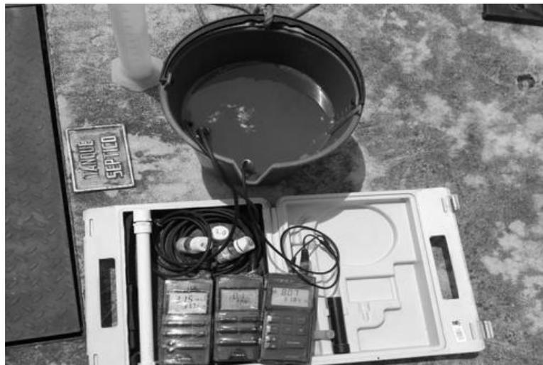
Medición de parámetros in situ (ph, conductividad, oxígeno disuelto y temperatura)
