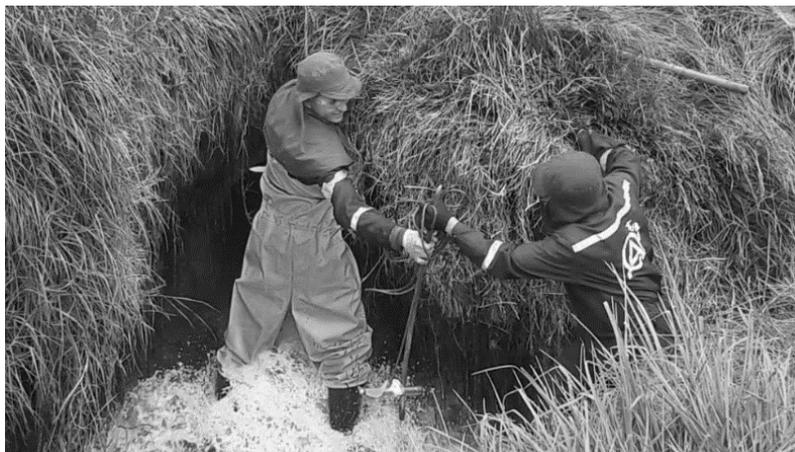
Se realiza la toma de muestra con un balde de masa de agua representativa, se lleva a un punto estable fuera del agua y se inicia con la medición de los parámetros PH, temperatura, oxígeno disuelto y conductividad.
