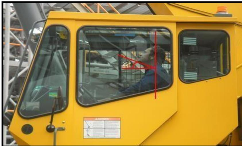
*Figura 18.. Operario de la grúa con cuello en posición extendida y lateralizado.*
