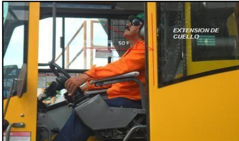
*Figura 17. Operario de la grúa con inadecuada inclinación del cuello.*
