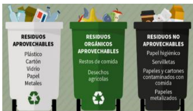
Ilustración 2 . Código de colores para la separación de residuos en la fuente a nivel nacional
