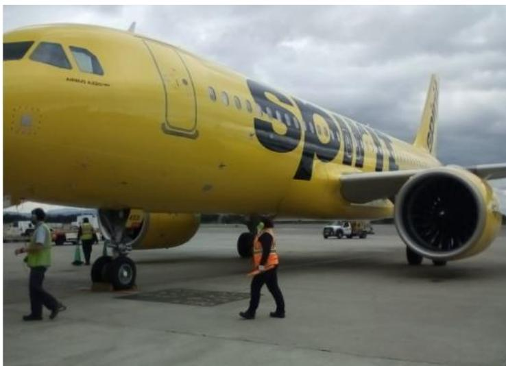
✓ **Colocación y retiro de Conos y cuñas.** Consiste en el bloqueo de las ruedas de los trenes de aterrizaje por medio de cuñas que se ubican adelante y atrás de las ruedas para prevenir que la aeronave se mueva, después que los frenos sean desactivados. Los conos por su parte identifican los puntos sensibles de la aeronave sirviendo como base para que todo el equipo tenga una aproximación limitada a ellos. (Tiempo definido de acuerdo a Carta Gantt 2 minuto)
