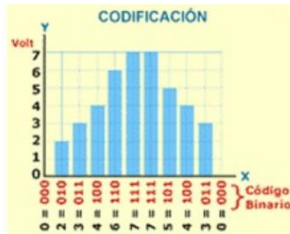
Figura 30 Etapa de codificación en la conversión A/D
