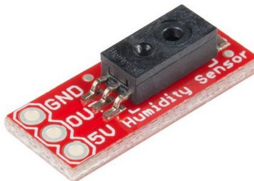
Figura 20 Partes del HIH4030
