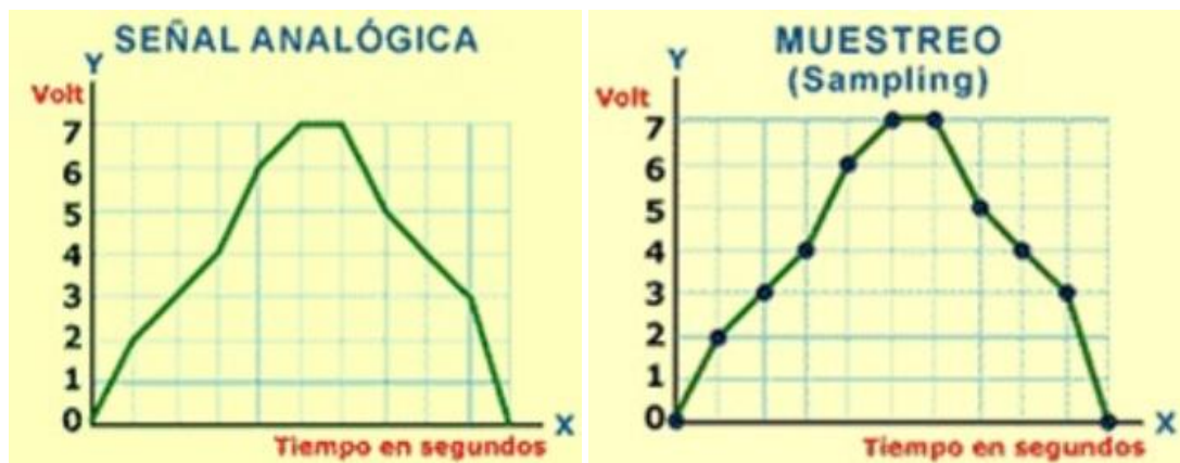
Figura 28 Etapa de muestreo en la conversión A/D
