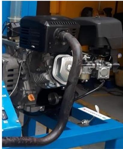
*Ilustración 24. Motor monocilíndricos Honda 270GX.
