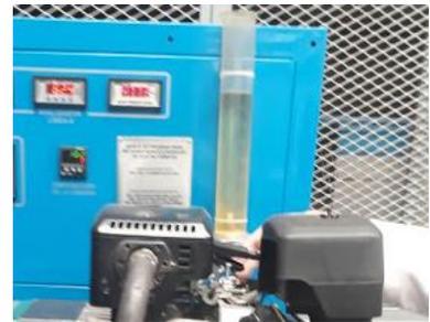
2. Realizar la correcta conexión de la batería, donde el cable de color rojo se ubica en el terminal rojo y representa el positivo, el cable amarillo se ubica en el terminal negro y representa el negativo.
