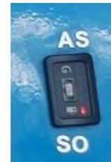
8. Revisar que el interruptor rojo ubicado en la caja de control de las resistencias se encuentre en la posición OFF, posteriormente se realiza el hale del cordón de arranque dos veces.
