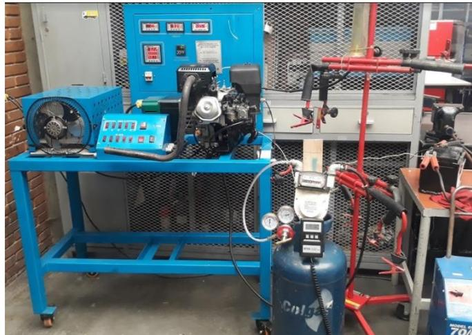
*Ilustración 31. Banco de Pruebas empleando gasolina y GLP.
