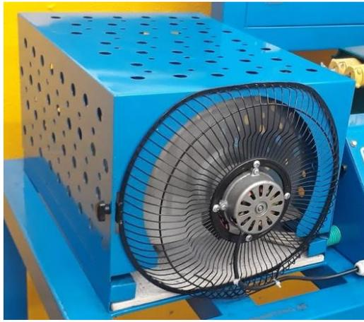
*Ilustración 29. Caja de resistencias con ventilación de aire forzado.
