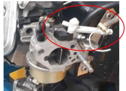
13. Cambiar de posición el interruptor rojo en ON y halar el cordón de arranque hasta conseguir el encendido del motor.
