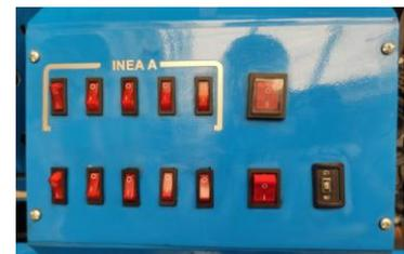
3. Activar el interruptor ubicado en la caja de control de resistencia para activar el ventilador para permitir la refrigeración en el interior de la caja de resistencias.
