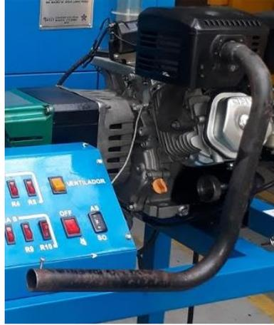
Ilustración 27. Tubo de Escape de motor de Banco de Pruebas.
