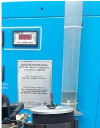
*Ilustración 23. Probeta de Gasolina del Banco de Pruebas.
