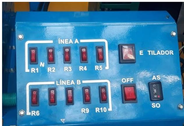
Ilustración 28. Caja de control de resistencias de carga eléctrica.
