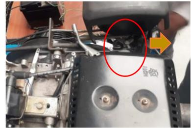
12. Desplazar la palanca del choque de carburador en sentido de las manecillas del reloj, para permitir el paso de aire al interior del cilindro.
