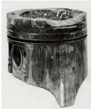
*Ilustración 11. Daño producido por detonación en un pistón.
