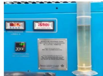
3. Acelerar el motor a régimen nominal de 3600 RPM (60Hz).
