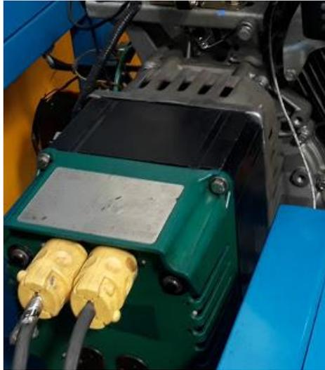
*Ilustración 30. Generador Maxa de 4000 Vatios de corriente alterna.
