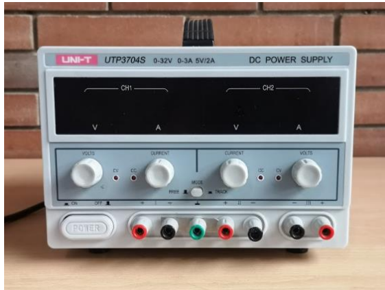
Figura 2.3 Fuente de voltaje utilizada en el proceso de anodizado de las muestras.
