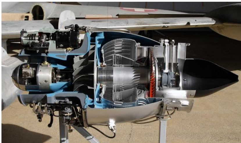
Figura 1.10 Corte de un motor Turbomeca Marbore II.
