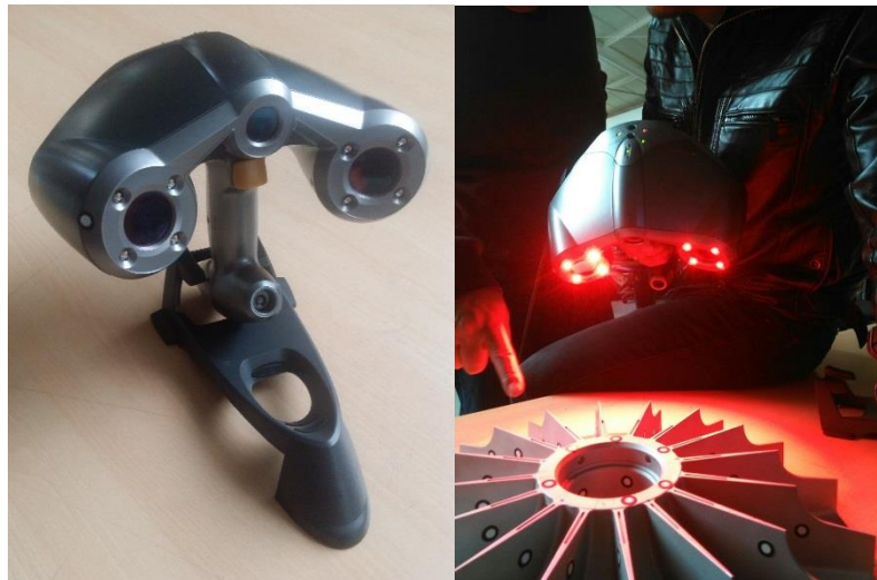
Figura 3.3 Proceso de escaneo 3D utilizando Escáner 3D ZScanner800 ZCORPORATION.
