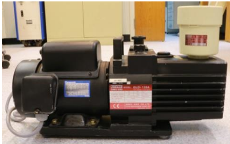
Figura 1.27 Fotografía de una típica bomba rotativa de vacío [63].
