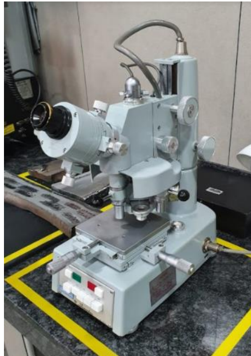
Figura 2.12 Micro durómetro marca Shimadzu de la empresa Tratamientos Ferrotérmicos S.A.S.
