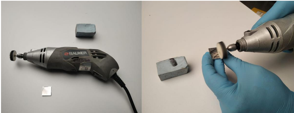
Figura 2.5 Proceso de pulido para acabado brillo espejo de las muestras.
