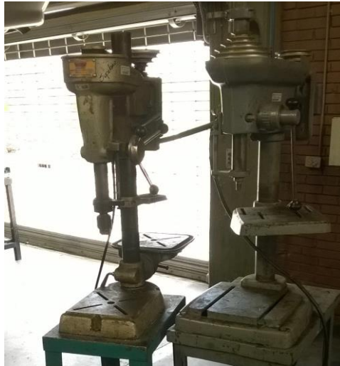
Figura 13 Taladro de árbol fuente catalogo taladros de columna fuente: autores
