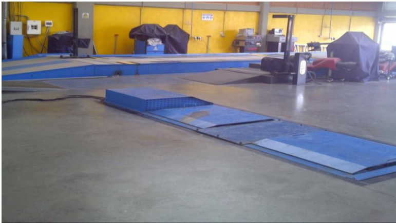
Figura 39. Dinamómetro mustang SENA CTT. Fuente: autores
