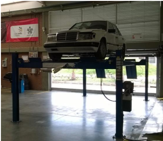
Figura 15 elevador 4 columnas. Fuente: autores
