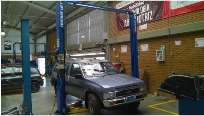
Figura 10 Elevador de 2 columnas fuente: Autores
