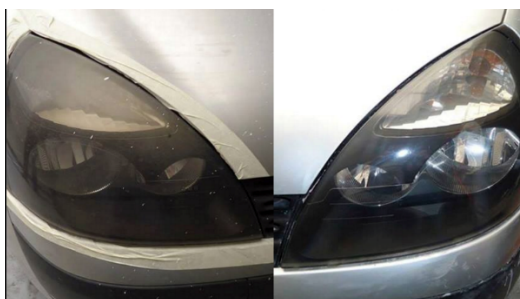
Figura 8. Restauración de farolas
