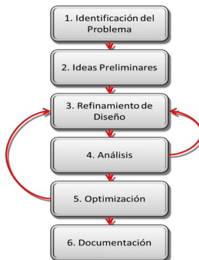
Figura 2. *Proceso Lineal de Diseño en Ingeniería.*
