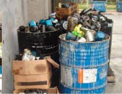
Acopio de filtros sin drenar en cajas de cartón, ocasionando derrames y contaminación.
