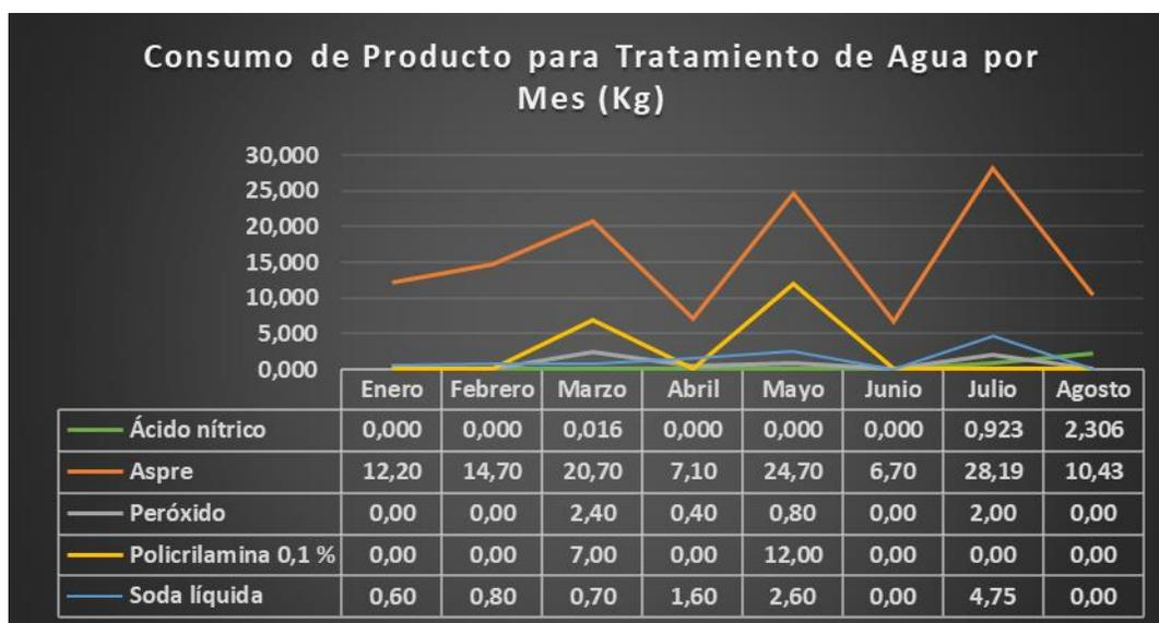
**Nota:** Este diagrama muestra los datos consolidados por cada producto utilizado para el tratamiento del agua utilizada en la operación de la sección de empaque de líquidos industriales – SELI. Fuente: Elaboración propia.
