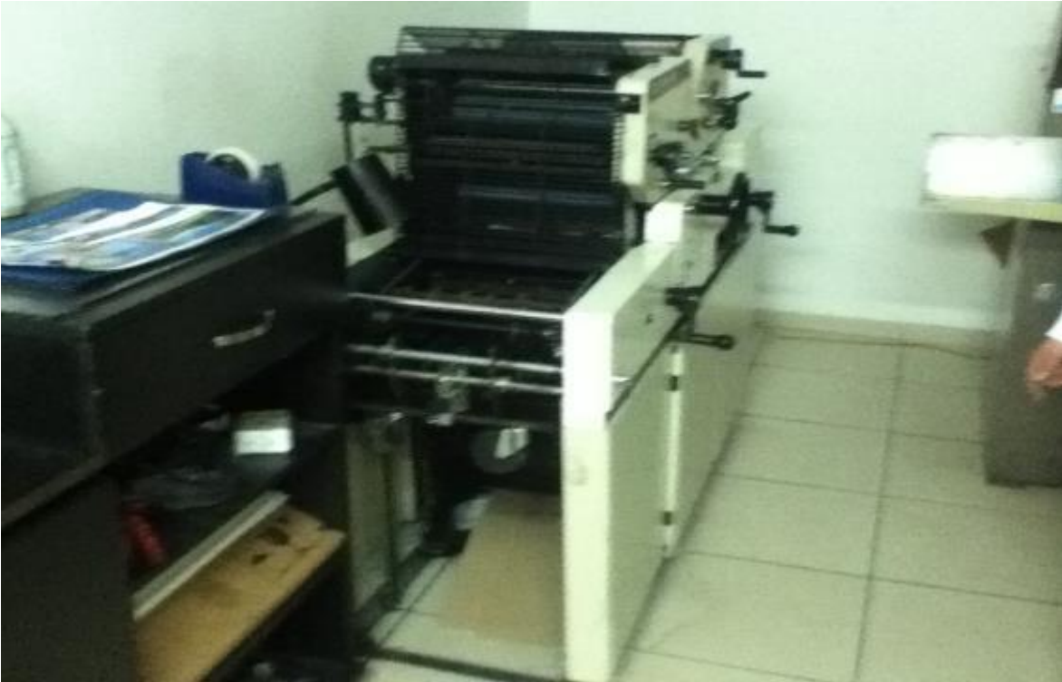
Imagen 6. Máquina de Impresión (Litográfica)
