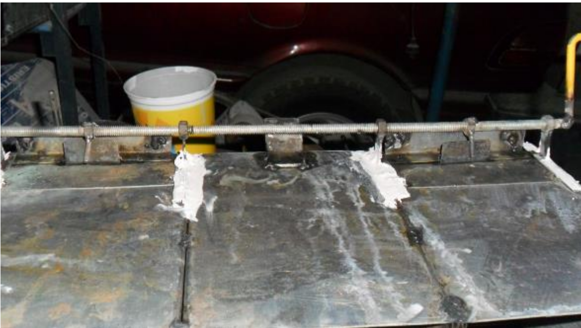
Imagen 18. Sistema de Calibrado del Dispositivo.
