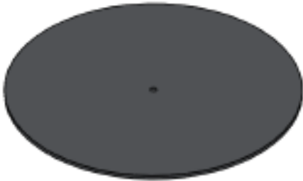
DISCO O CHAPA TROQUELADA ANTES DE SER REPUJADA Y/O EMBUTIDA.
