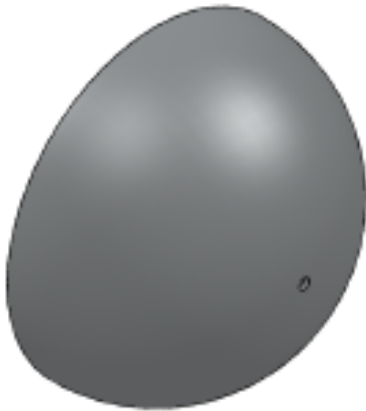
CASCO REPUJADO Y/O EMBUTIDO, LISTO PARA SER SOLDADO.
