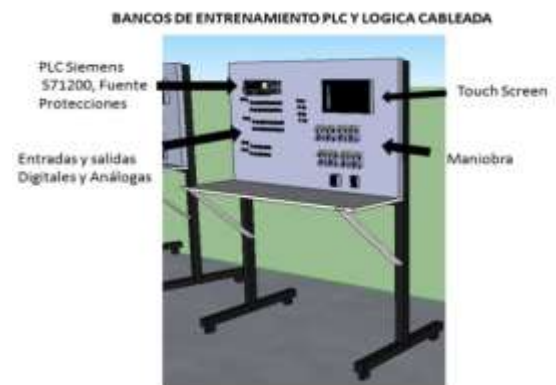
Fig. 1. Esquema del banco de prueba usado en el laboratorio.
