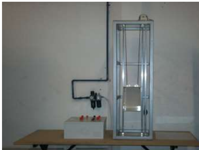
Figura 12. Fotografía de la planta piloto ascensor. 22
