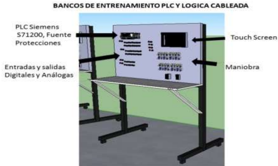
Figura 7. Esquema del Banco de prueba con PLC. 16
