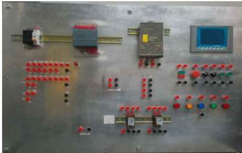
Figura 8. Fotografía de la distribución de los componentes en el tablero. 17
