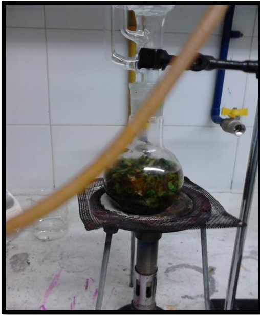
Modelo para la extracción de los compuestos de Brugmansia candida método soxhlet
