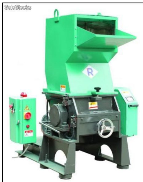
Figura 23. Molino para plástico con alimentación forzada (Profile granula). Tomado de Fuente. www.machine.md.com
