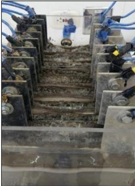
*Figura 12.* Lodos en el proceso de electrocoagulación. Foto: Autores.
