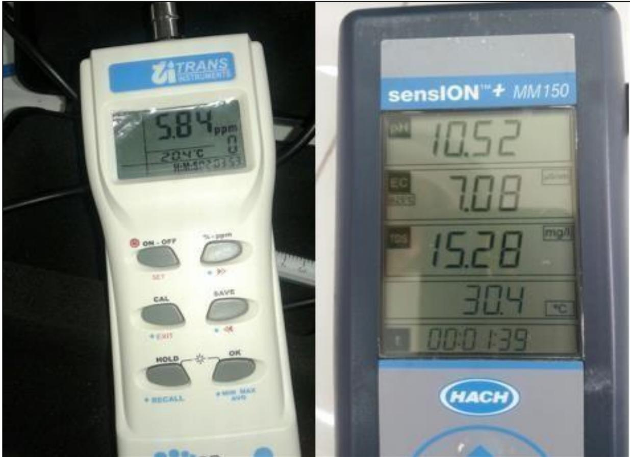
*Figura 15.* Equipos para la medición de parámetros Multiparametro (Derecha) y Oxímetro (Izquierda) Foto. Autores
