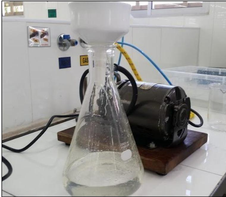
*Figura 13.* Filtración con el equipo de bomba de vacío. Foto. Autores.
