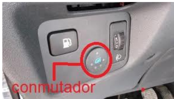
Grafica 49. Instalación llave conmutadora.
