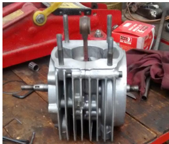
Imagen 7. Montaje conjunto cigüeñal-biela
