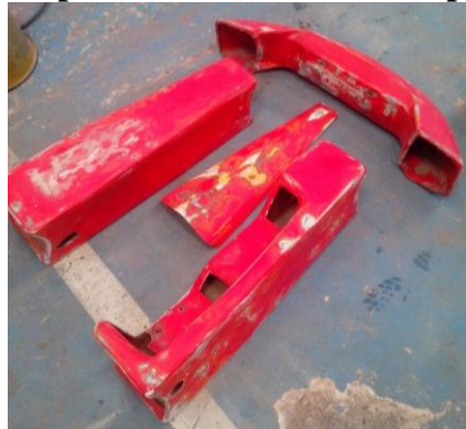
Imagen 32. Preparación de la carrocería para pintura.
