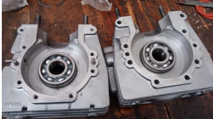
Imagen 4. Cambio rodamientos cigüeñal.
