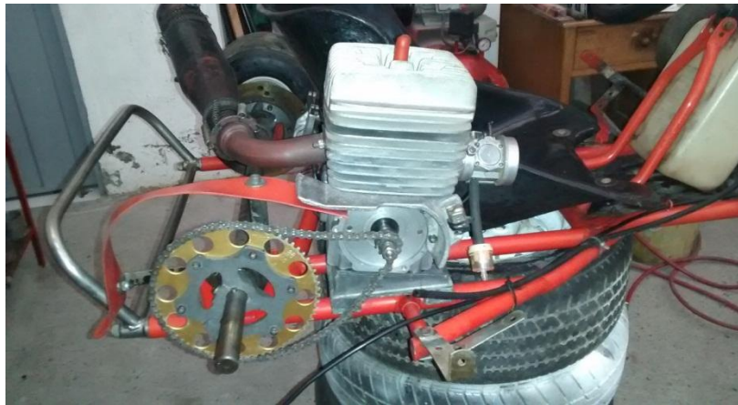
Imagen 21. Montaje escape, carburador, kit de arrastre con el resto de accesorios.
