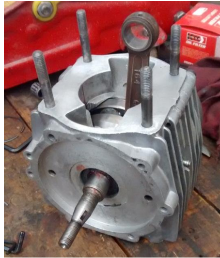
Imagen 8. Montaje conjunto cigüeñal-biela lubricado
