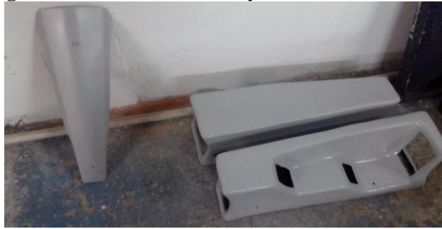
Imagen 33. Pintura con base y fondo de la carrocería.
