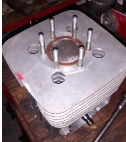
Imagen 14. Montaje de empaque de culata a cilindro.
