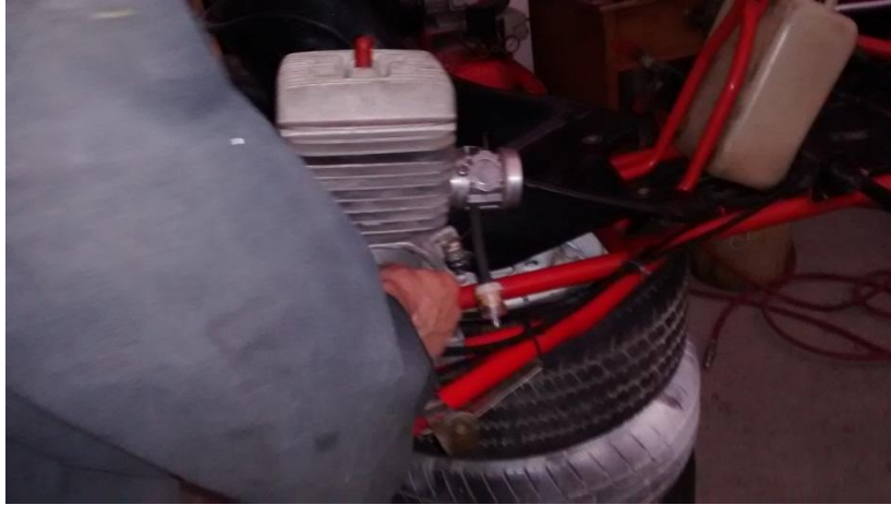
Imagen 20. Montaje motor a chasis.
