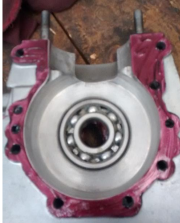
Imagen 6. Eliminador de empaque en carcasas de Carter.
