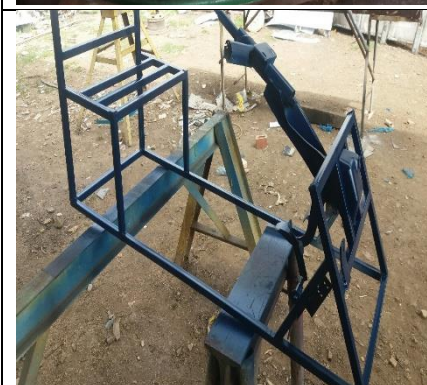
Figura 15. Proceso de pintura azul sobre el prototipo en el cual se aplica pintura esmalte con pistola aerográfica neumática
