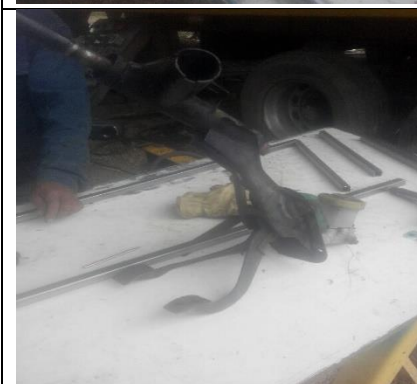
Figura 12. Sistema de pedales de un vehículo de la marca Renault 4 para la activación del freno de ahogo mediante los microswitch instalados en estos.
