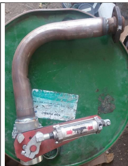
Figura 14. Proceso de ensamble del freno de ahogo con el codo en acero de 3'' mediante un proceso de soldadura autógena.
