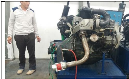
Figura 17. Instalación de freno de ahogo en múltiple de escape de motor Mitsubishi 4DL6
