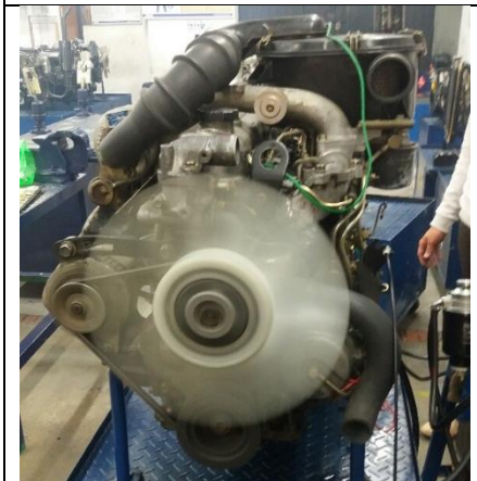
Figura 18. Alistamiento de motor Mitsubishi para pruebas de desempeño del freno de ahogo.
