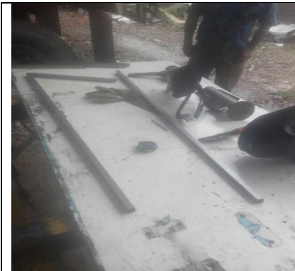
Figura 10. Ensamble de la estructura del prototipo en tubo cuadrado de 1/2 '' en acero.
