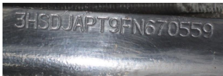
Figura 2. Número VIN grabado en el chasis tracto camión Prostar.
