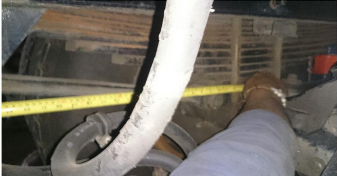
**Figura 15** medición suspensión en Kenworth T370, foto tomada por el grupo.
