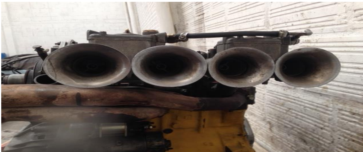
Ilustración 24 Entradas de aire carburadores weber.
