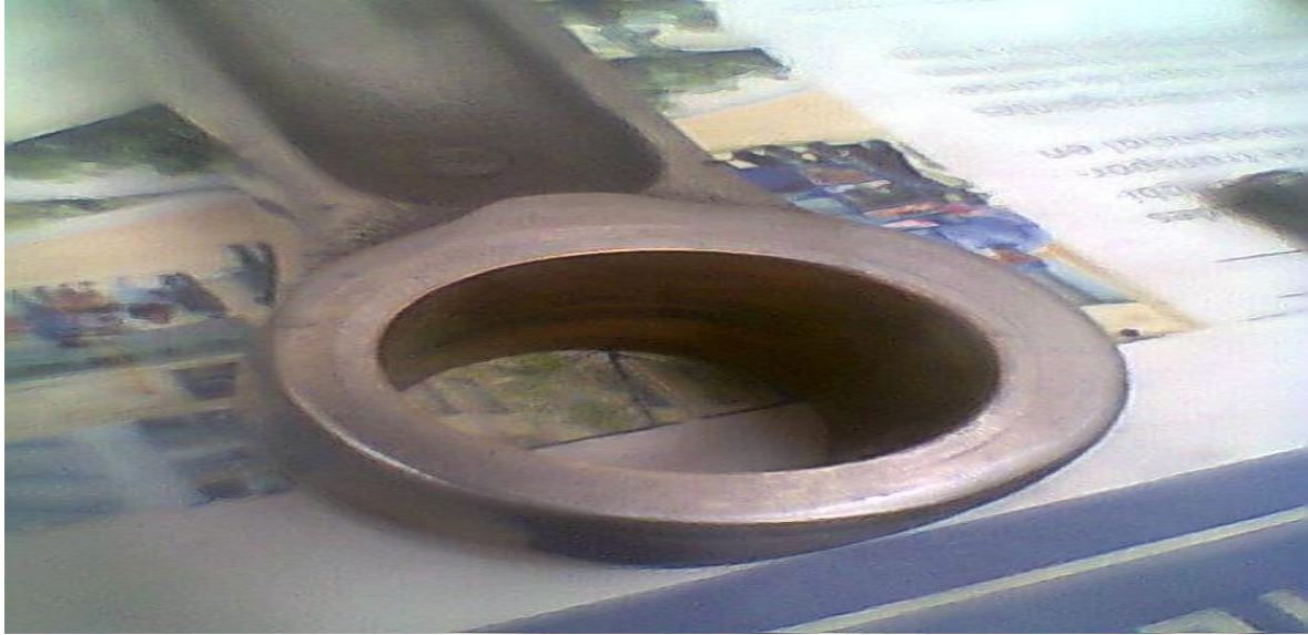
Ilustración 28 Bujete de bronce en pie de biela
