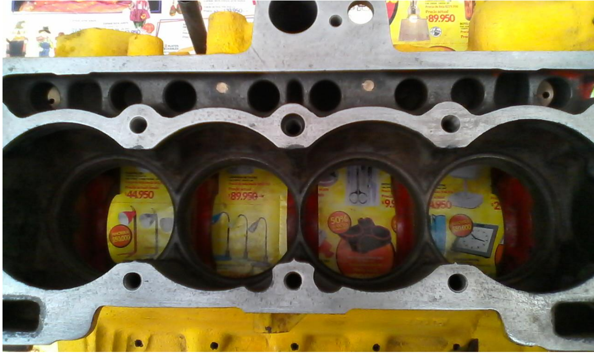
Ilustración 4 Bloque maquinado para camisas de 1400 cc
