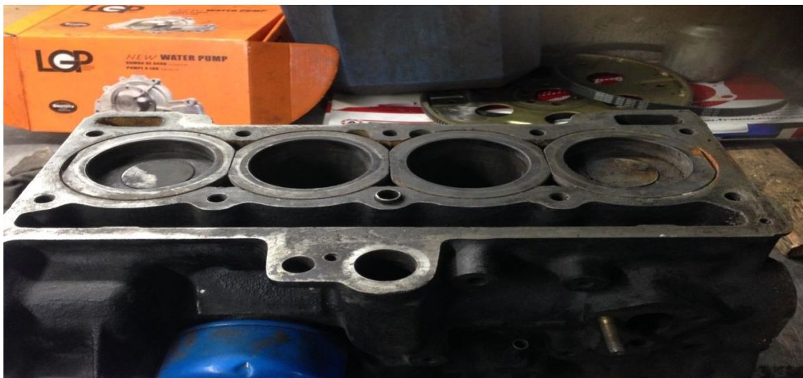
Ilustración 3 Bloque de serie
