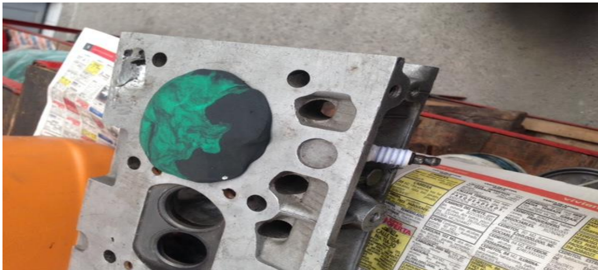
Ilustración 7 Medición volumen cámaras de combustión trucadas
