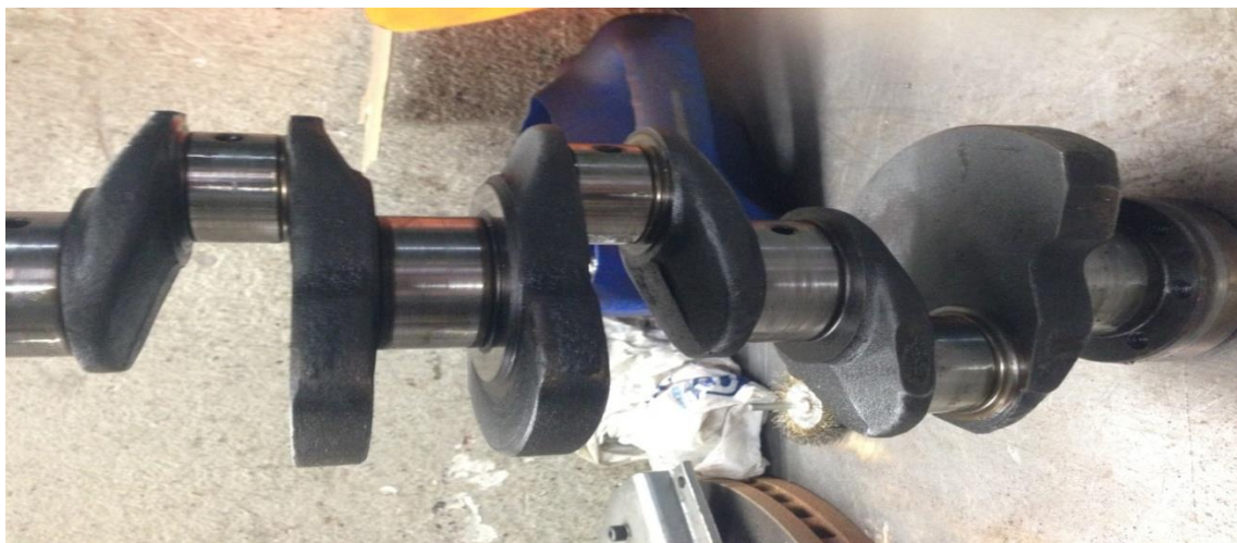
Ilustración 29 Contrapeso cigüeñal de serie
