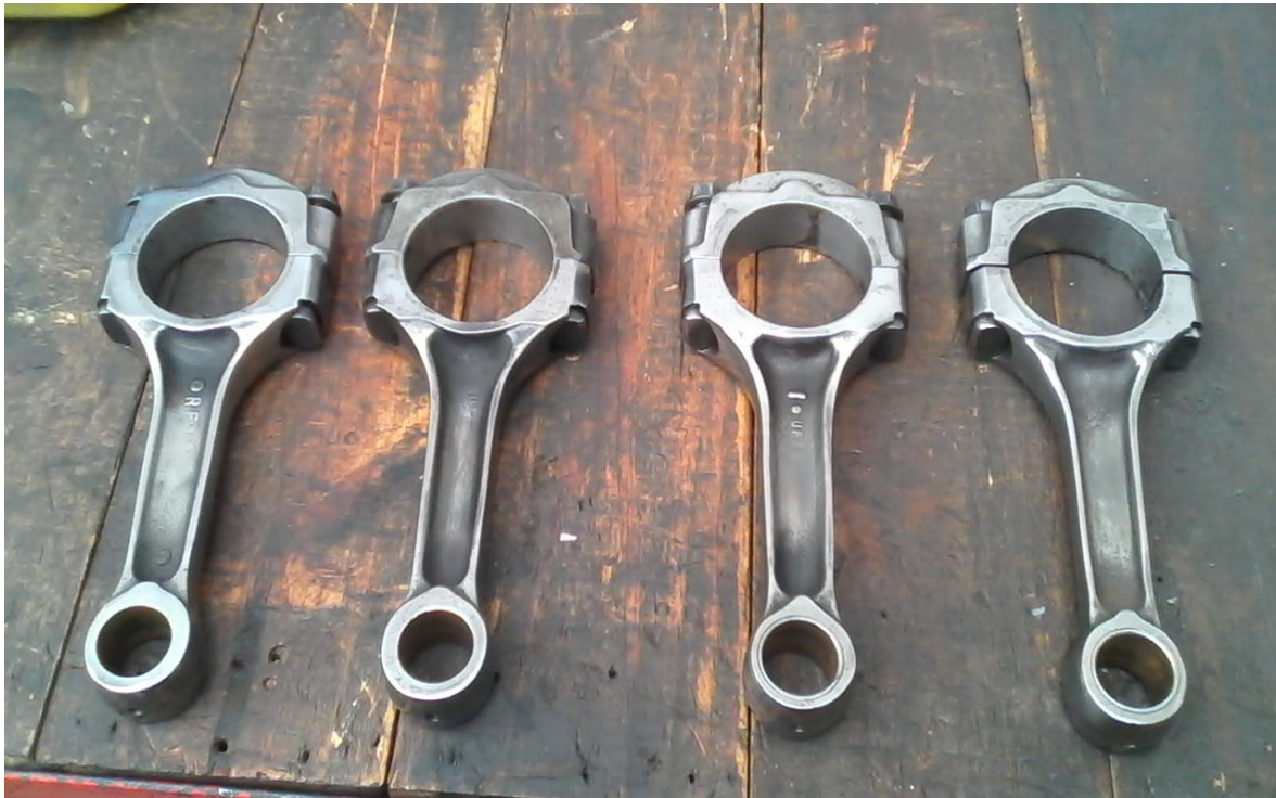
Ilustración 27 Bielas aligeradas, brilladas y con buje de bronce
