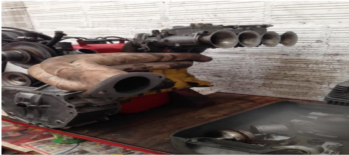
Ilustración 23 Carburadores dobles weber horizontales
