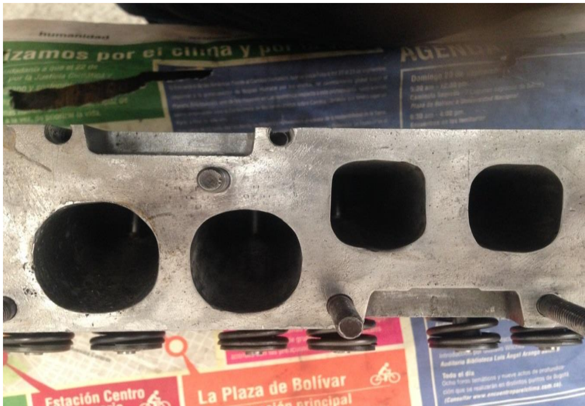
Ilustración 19 Lumbreras de admisión y escape porteadas
