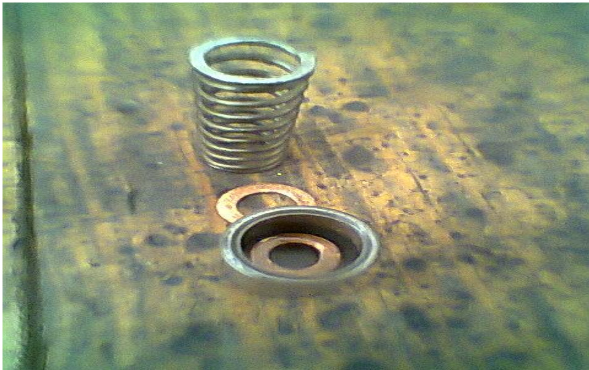
Ilustración 34 Suplementos para conseguir mayor presión
