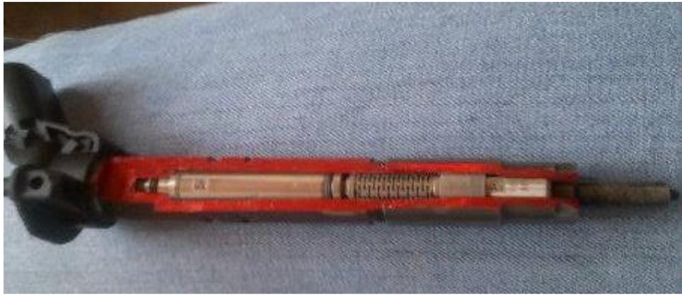
*Figura 8. Primer inyector de riel común pintado con el esmalte para diferenciar el corte seccionado en el material.
