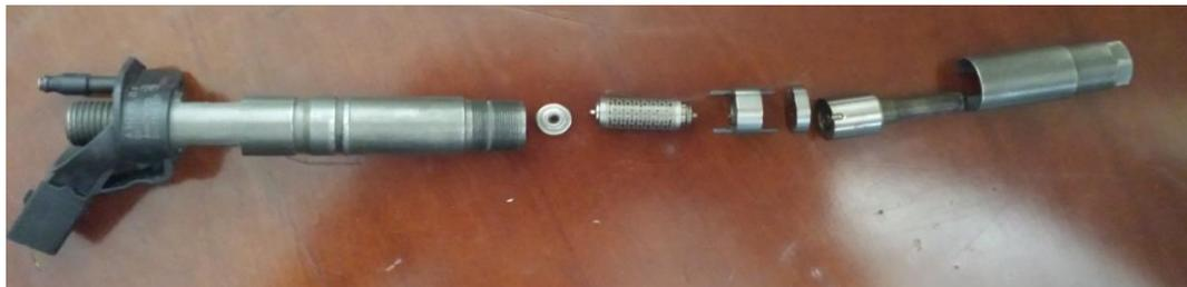
*Figura 2. Desglose de los componentes internos del inyector con la punta de la tobera y la porta-tobera.
