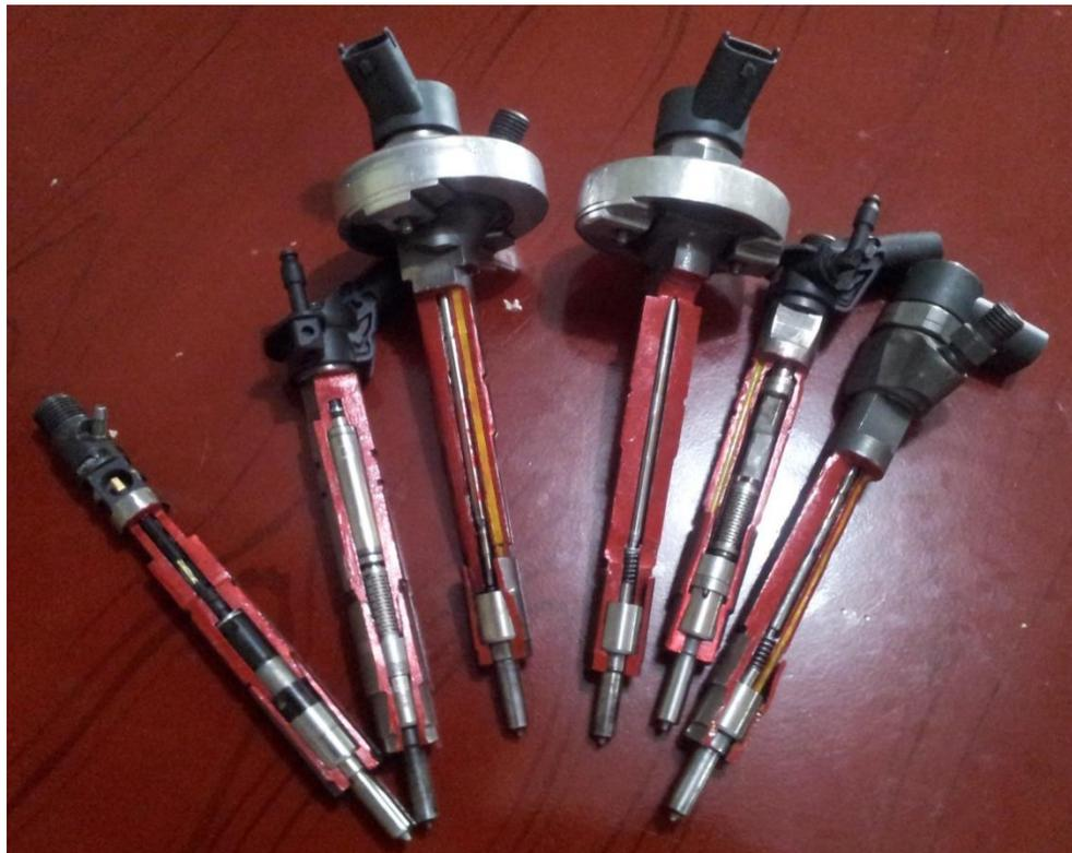
*Figura 9. Presentación final de los inyectores de riel común, el color ROJO identifica el corte del material y el color AMARILLO identifica los conductos por donde fluye la gasolina.
