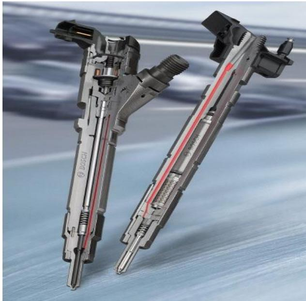
Ilustración 15. Ejemplo de corte seccionado al inyector de riel común marca BOSCH. Ubicación: <http://www.tallerdemecanica.com/inyectores-de-coomon-rail/26-r.html>
