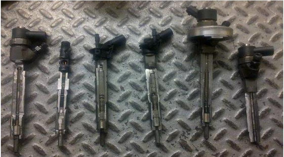
*Figura 5. Resultado final del corte seccionado de los inyectores de riel común.
