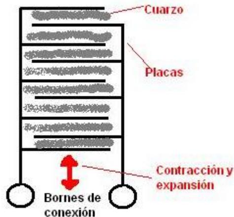
Ilustración 8. Representación del piezoeléctrico de un inyector Diesel. Ubicación: <http://www.cise.com/portal/notas-tecnicas/item/140-funcionamiento-de-inyectores-piezoelectricos.html>
