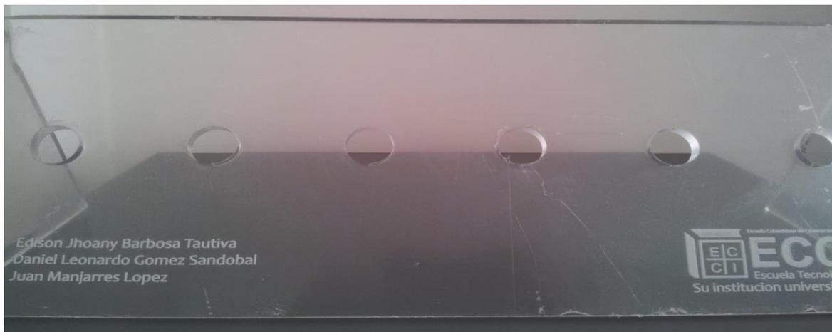
Figura 6. Diseño final de la maqueta de exposición hecha en acrílico transparente con 6 alojamientos para los inyectores de riel común, a la izquierda los nombres de los integrantes y a la derecha el logo principal de la universidad.
