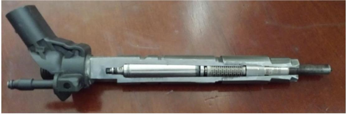
*Figura 4. Primer inyector seccionado con visualización total de sus componentes internos, acabado con lima fina y pulido.
