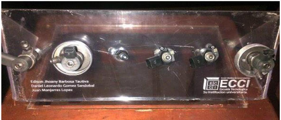
*Figura 10. Presentación de la maqueta con los inyectores de riel común ubicados en sus respectivos alojamientos.
