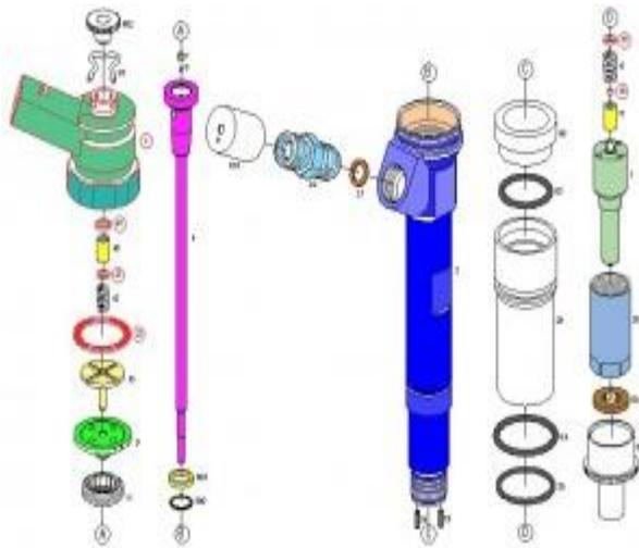
Ilustración 14. Desglose de las piezas externas e internas del inyector de riel común marca BOSCH. Ubicación: <http://www.tallerdemecanica.com/inyectores-de-coomon-rail/26-r.html>
