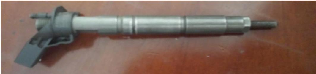
*Figura 1. Cuerpo del inyector de riel común.
