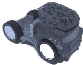
**Figura 4.** Vehículo modificado para pruebas de funcionamiento en pista, masa de 34 gramos, materiales de plástico y aluminio en plataforma.
