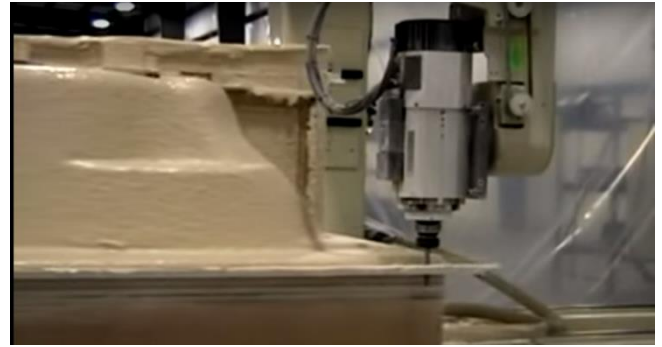
Figura 6 Corte Exceso de material ( https://www.youtube.com/watch?v=nHq5_4jbo8 )
