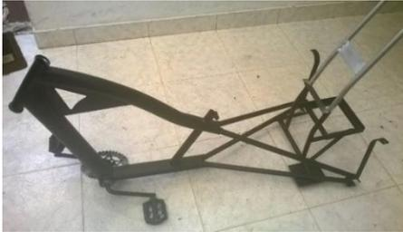
Pintura: Se realiza el proceso con pintura electroestática garantizando el adecuado cubrimiento de las piezas con sus respectivos acabados.
