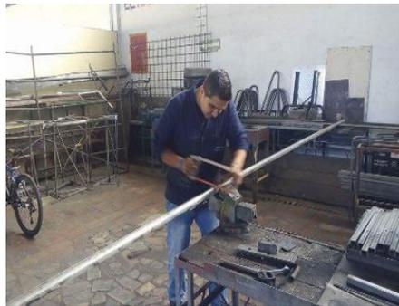
Ilustración 42. Corte y doblado de materiales. Autores
