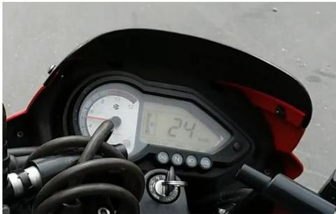
La velocidad adquirida en los 46 metros fue de 24 Km/h, esta distancia y velocidad se adquirió en 14 segundos contando con un peso en el triciclo de 61 kg.
