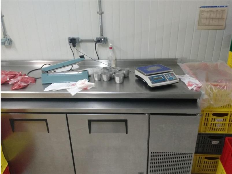
**Descripción: 5 Método de empaque actual, mediante una báscula y una selladora térmica, pesando y empacando unidad por unidad.**
