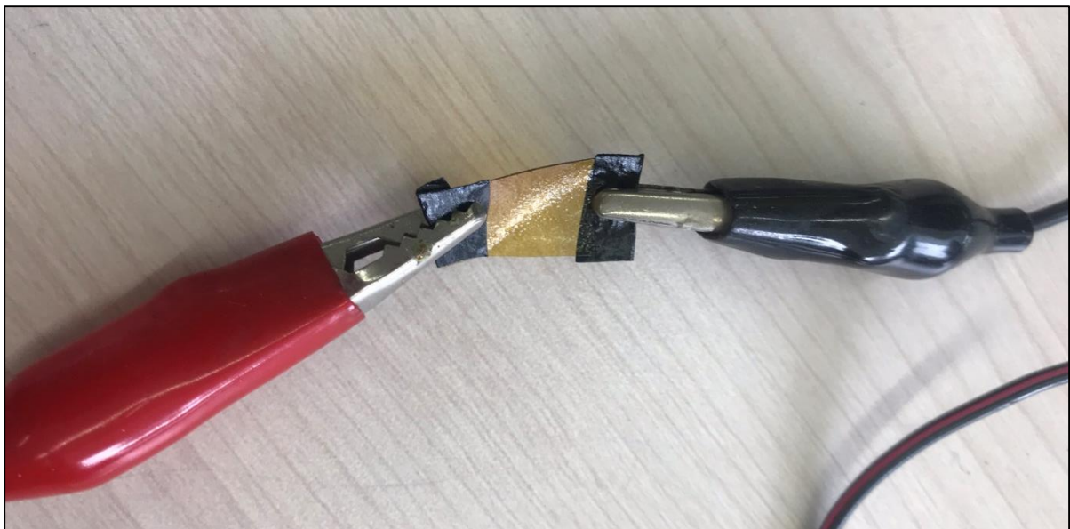
Imagen 19. Película de quitosano con oro en la superficie.
