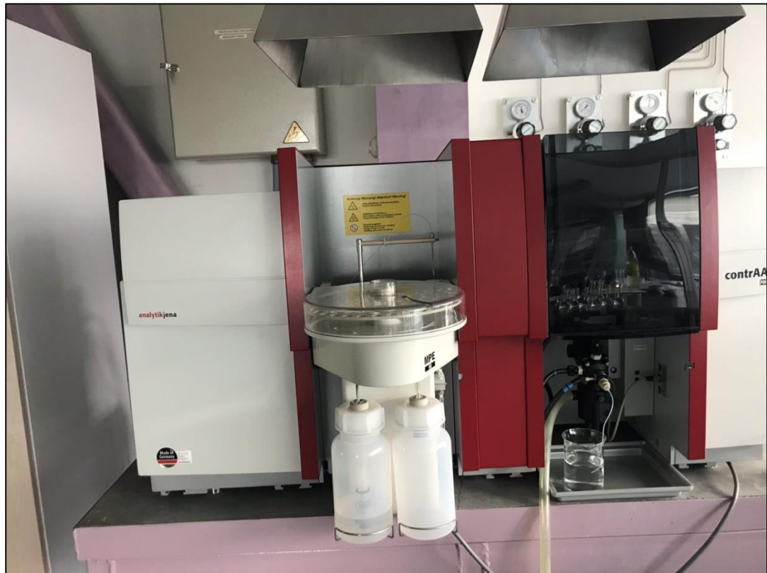
Imagen 17. Equipo de espectrofotometría de absorción atómica.
