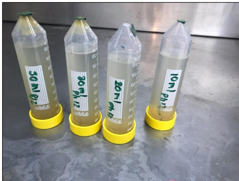
Imagen 11. Las muestras de Quitosano con agua del Embalse el Muña modificando el pH a 12
