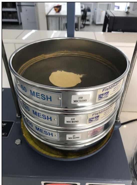
Imagen 1. Tamizador Gilson con las rejillas de 63, 125 y 250 micras, de la universidad ECCI
