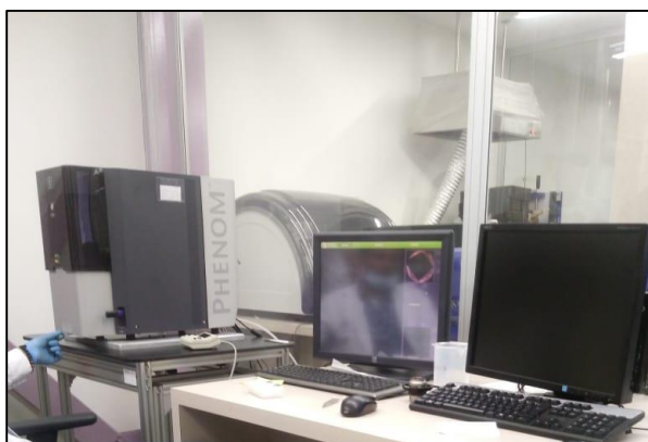
Imagen 5. Microscopio electrónico de Barrido (SEM), marca PHENOM, de la universidad ECCI.
