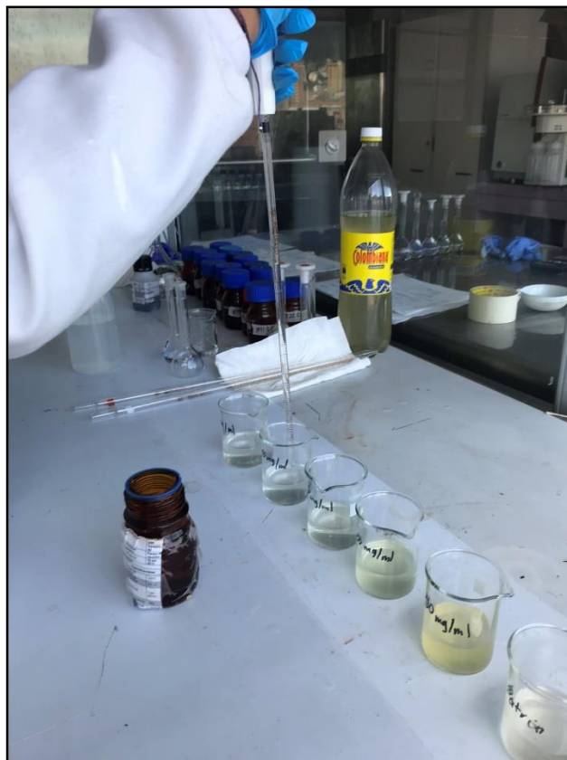
Imagen 14. Adición de ácido nítrico y peróxido de hidrogeno a las muestras de quitosano con el agua del embalse el Muña.
