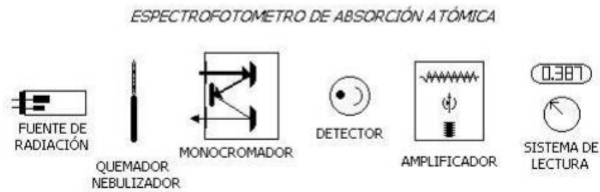
Figura 3. Componentes de un Espectrofotómetro de Absorción Atómica.
