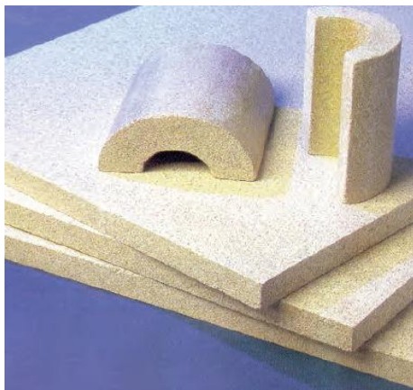
Ilustración 12. Vermiculita, aislante térmico con uso común en la construcción.
