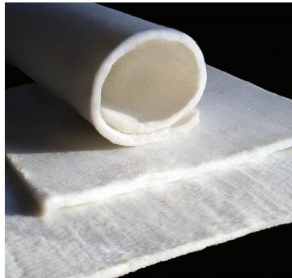
Ilustración 11. Aerogel, aislante térmico con baja conductividad termina
