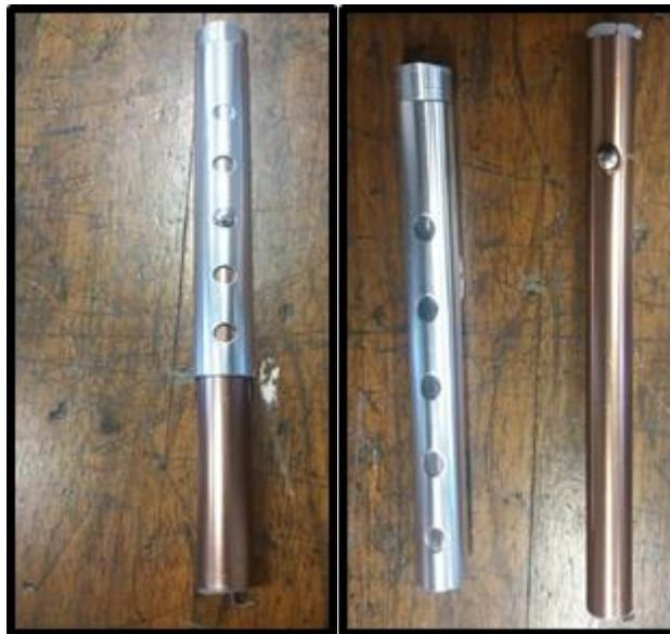
El primer prototipo fabricado es un báculo retráctil en escala 1:1 con una punta metálica de alambre dulce, el cual es el que se ancla a una de las puntas de la pulsera sosteniéndola con firmeza sobre la muñeca; tal como se ilustra en la imagen.
