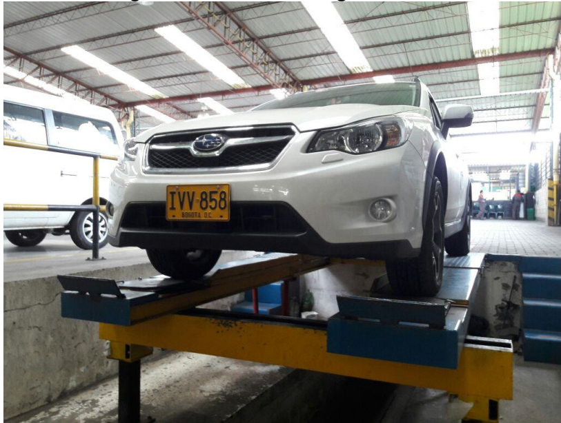
Figura 11. Se verifican fugas de aceite.
