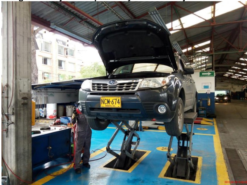
Figura 10. Ajusta suspensión y tren de rodaje del vehículo.
