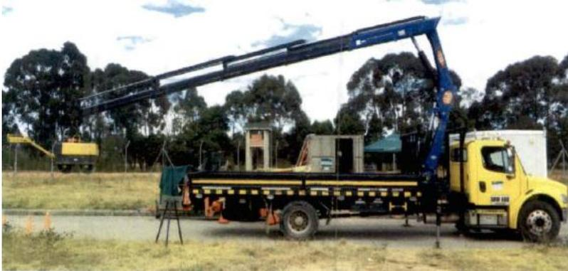
Figura 9. Camión grúa sobre camión, Capacidad de 8 Toneladas. Izaje no crítico.
