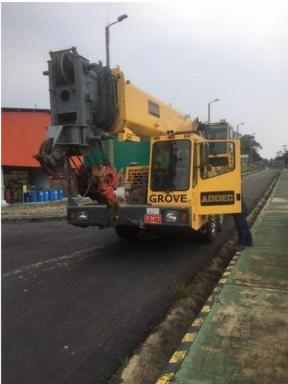
Figura 11. Grúa telescópica hidráulica, Capacidad 60 Toneladas.
