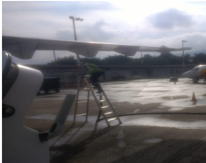
Figura 30. Abastecimiento de la aeronave; trabajo en altura sin protección
