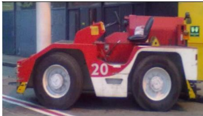
Figura 23. Tractores de empuje
