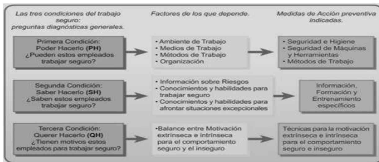
Figura 7. La teoría tricondicional: Las tres condiciones para el trabajo seguro, factores de los que depende y grupos de medidas de acción preventiva implicadas
