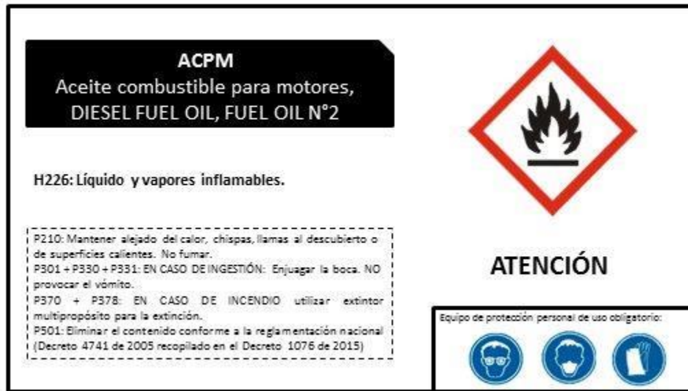
ILUSTRACIÓN 15. ETIQUETA CONTENEDOR DE ACPM
