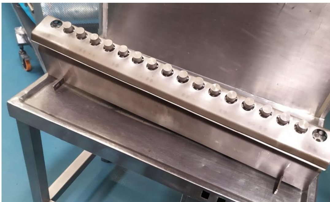
Bafle del freidor desinstalado
