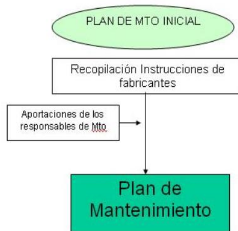
Figura 1. Diagrama de flujo para la elaboración de un plan de mantenimiento basado en las recomendaciones de los fabricantes. Fuente: (Sánchez Sánchez de Puerta, 2016)
