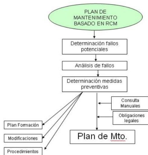
Figura 2. Diagrama de flujo de la elaboración del plan de mantenimiento basado en el análisis de fallas Fuente: (Sánchez Sánchez de Puerta, 2016)
