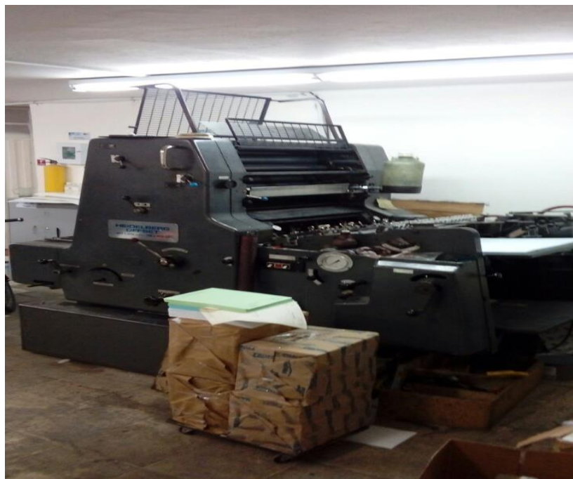
Ilustración 2 HEIDELBERT T-OFFSET 48 x 65 Cm IMPRESIÓN MONOCOLOR.
