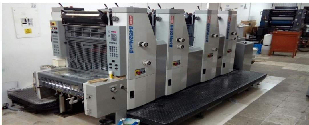
Ilustración 1 HAMADA B452 MARKII IMPRESIÓN A CUATRO COLORES.
