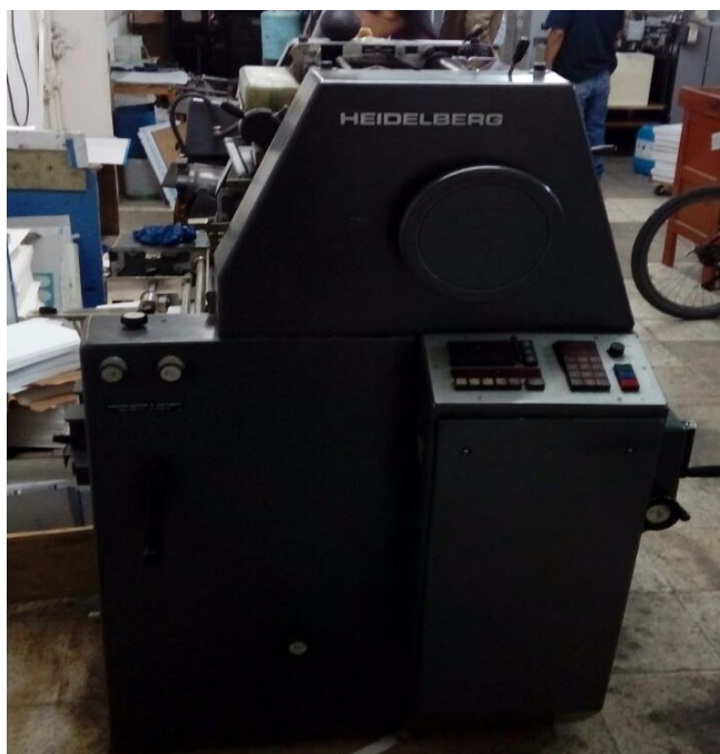
Ilustración 4 HEIDELBERG T-OFFSET 28 X 39 Cm IMPRESIÓN MONOCOLOR.
