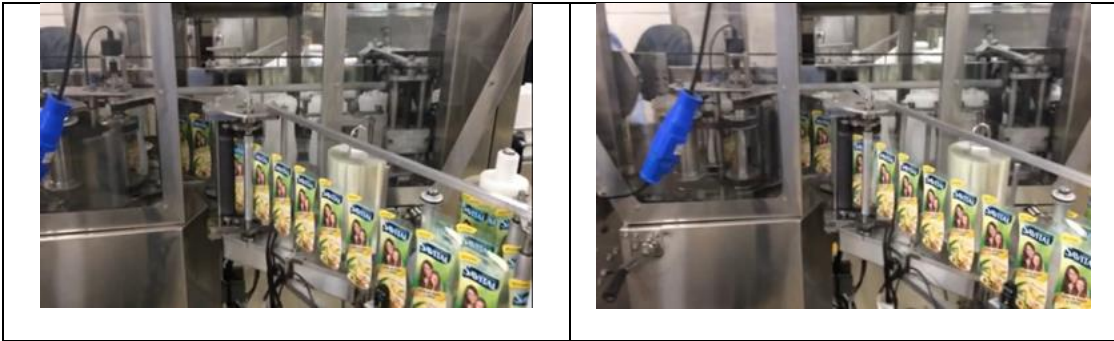
Figura 30. Peque de etiquetas por el equipo, 84 unidades por minuto Fuente: El Autor
